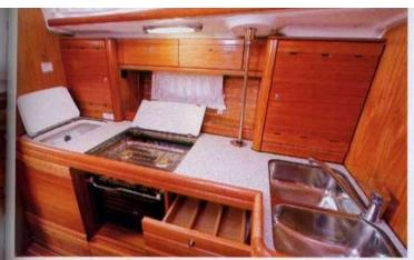
Materiali: controstampo per cielini, sky pareti, legno - Ventilazione: un osteriggio - Illuminazione naturale: buona - Illuminazione artificiale: due alogene - Volumi gavoni e armadi: gavoni sottoletto e seduta, diversi stipetti aparete, armadio - Rumorosità motore in navigazione: 69 dBA.
